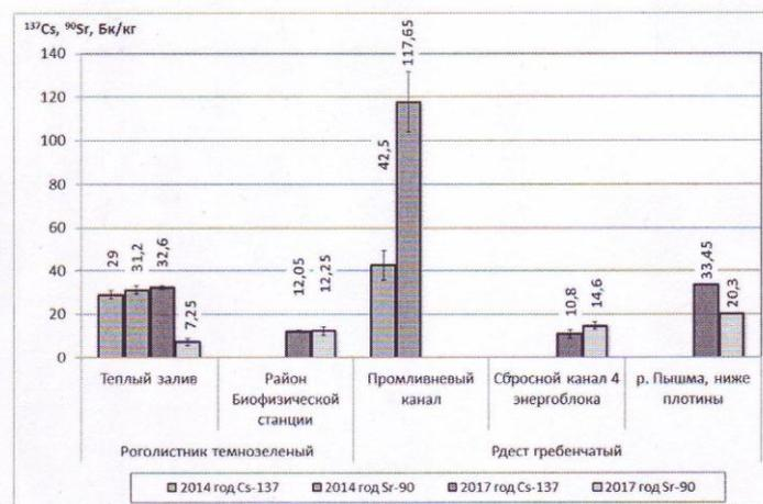
Рис. 2. Содержание  $^{137}\text{Cs}$  и  $^{90}\text{Sr}$  в водной растительности водоема – охладителя Белоярской АЭС в 2014 и 2017 гг.
