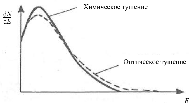
Рис. 1.19. Примеры сдвигов спектров при химическом и оптическом тушении [Packard Instrument..., 1995]
