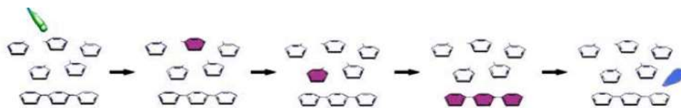
Рис. 1.16. Механизм передачи возбуждения в молекулах сцинтиллирующего коктейля
