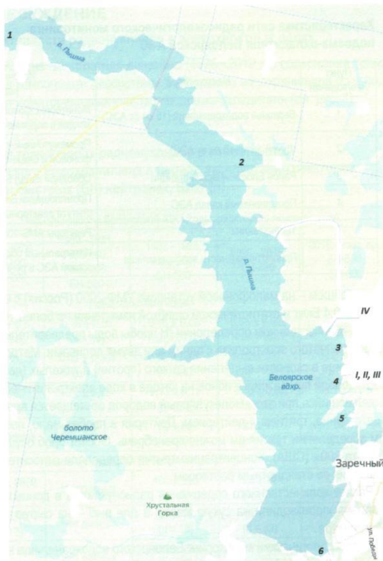
Рис. 1. Карта-схема сети радиозоологического мониторинга водоема-охладителя Белоярской АЭС: 1 – Верховье водохранилища; 2 – Щучий залив; 3 – район Биофизической станции; 4 – Промливневый канал АЭС; 5 – Теплый залив; 6 – приплотинная часть водохранилища. Реакторы Белоярской АЭС: I – АМБ-100, II – АМБ-200, III – БН-600, IV – БН-800
