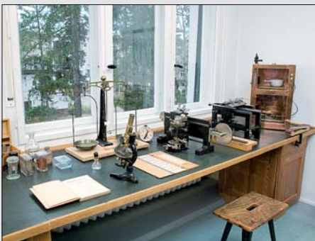
Abbildung 1 Histologischer Arbeitsplatz mit Paraffinschrank für die Einbettung von Organproben in Paraffinblöcke (hinten, rechter Bildteil); Mikrotomen (siehe Abb. 7 und 8) zur Herstellung von Dünnschnitten durch die in Paraffinblöcken eingebetteten Gewebeproben; Farblösungen (Tinkturen) (Bildmitte links mit Reaktionsgefäßen) zur differenzierten Färbung verschiedener Gewebe- und Zellstrukturen; Mikroskopen (siehe Abb. 9) zur Analyse der histologisch-zytologischen Struktur biologischer Materialien (Zellen/Gewebe).
