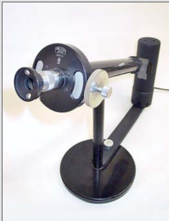
Abbildung 14 Pulfrich-Refraktometer zur Bestimmung des Brechungsindex von Substanzen, das so zur Bestimmung der Konzentration von Stoffen, zum Beispiel von Eiweißen, Zuckern oder Salzen in Lösungen verwendet wird. Fa. Carl Zeiss (Jena; Baujahr etwa 1940).
