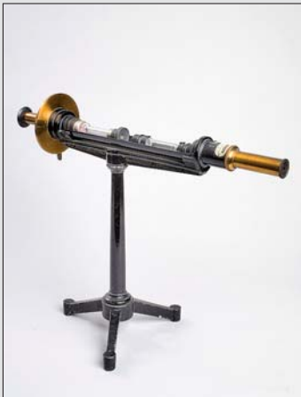
Abbildung 11 Aktinometer nach Michelson der Fa. Mating & Wiesenberg (Potsdam; Baujahr ca. 1950) zur Spektralanalyse von Lichtquellen.
