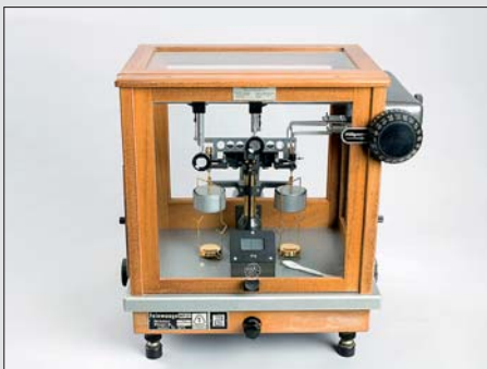
Abbildung 19 Mikrowaage für Wägungen von Substanzen bis zum Minimalbereich von 1/1.000 \text{ g} = 1 \text{ mg} . Fa. W. Zschörnig K. G./F. Küstner (Dresden/Freiberg; Baujahr 1960).
