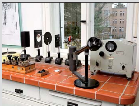
Abbildung 2 Labortisch mit »Optischer Bank« als Absorptions-Spektrophotometer nach Erwin Negelein (etwa 1950) und einem Pulfrich-Refraktometer. Die »Optische Bank« ist eine Gerätekombination zur Messung des Ablaufes chemischer Prozesse, die mit Veränderungen der Absorption von Licht definierter Wellenlänge(n) durch Veränderungen (zum Beispiel Oxydationen oder Reduktionen) von Reaktionspartnern verbunden sind. Die Veränderungen werden durch eine Photozelle gemessen und können an einem Galvanometer (rechts) registriert werden. Über das Pulfrich-Refraktometer (siehe Abb. 14).
