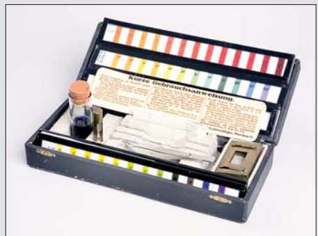
Abbildung 16 Farb-Testbesteck der Fa. F. & M. Lautenschläger (München) aus dem Jahr 1900 zur Bestimmung des pH-Wertes (Wasserstoffionen-Konzentration) mit pH-spezifischen Farbindikatoren. Die Messung erfolgt durch Zugabe der Indikatoren und nachfolgendem Abgleich der Färbung in der zu prüfenden Lösung mit entsprechenden Farbskalen für verschiedene pH-Werte.
