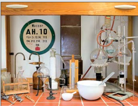
Abbildung 6 Chemischer Arbeitsplatz unter einem Abzug etwa 1950. Verwiesen sei insbesondere auf einen Kipp'schen Apparat zur Herstellung von Gasen (zum Beispiel Wasserstoff, Sauerstoff, Kohlendioxid, Schwefelwasserstoff) auf der Basis chemischer Prozesse, zum Beispiel der Reaktion von Zink mit Salzsäure, wobei gemäß Zn+2HCl=ZnCl_2+H_2 (Zinkchlorid und Wasserstoff) gebildet werden.
