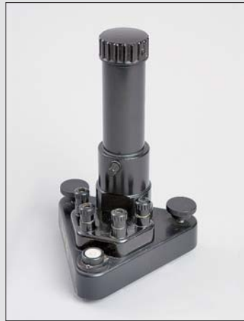
Abbildung 18 Von dem niederländischen Physiologen Willem Einthoven 1903 entwickeltes Galvanometer zur Registrierung geringer, zum Beispiel aus dem Gehirn oder dem Herzen abgeleiteter Aktionsströme. Für seine Arbeiten über den Mechanismus der Elektrokardiographie erhielt Einthoven 1924 den Medizin-Nobelpreis.
