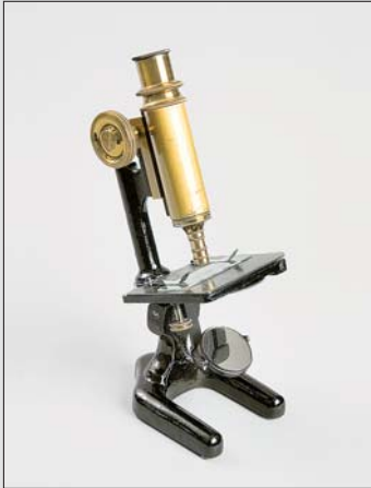
Abbildung 15 Mikroskop der Fa. Paul Waechter (Friedenau-Berlin; Baujahr 1880) mit ausziehbarem Schiebetubus zur Grobeinstellung und Feineinstellung durch Tischneigung per Schraube unter dem Objektivtisch. Gerät mit mehrteiligem Objektiv mit verschiedenen austauschbaren Objektivlinsen und Lochblendenscheibe.
