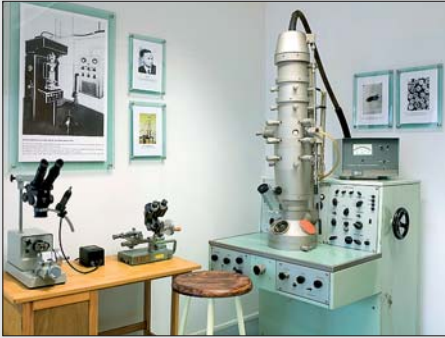
Abbildung 3 Arbeitsplatz für die Elektronenmikroskopie mit einem Elektronenmikroskop des Werkes für Fernsehelektronik Berlin (Baujahr 1966), Auflösungsvermögen etwa ein Nanometer (durch elektronenoptische und lichteoptische Nachvergrößerungen ist eine Gesamtvergrößerung von 1.000.000 : 1 erreichbar) sowie mit zwei Ultramikrotomen mit Präpariermikroskopen (Baujahre 1955 und 1970) zur Herstellung ultradünner Gewebeschnitte für die Elektronenmikroskopie. Schautafeln enthalten einige Informationen zur Geschichte der Elektronenmikroskopie, außerdem wird als Kopie die Nobelpreis-Urkunde für Ernst Ruska aus dem Jahr 1986 für seine Arbeiten zur Entwicklung und den Bau des Elektronenmikroskops gezeigt.
