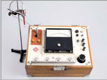
Abbildung 17 pH-Meter zur elektrochemischen Bestimmung der Wasserstoffionen-Konzentration in wässrigen Medien mit Meßelektrode. Fa. Clamann & Granert (Dresden; Baujahr 1966).
