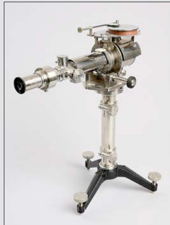
Abbildung 10 Mikroskop der Fa. Eduard Messter (Berlin; Baujahr um 1890) mit ausziehbarem Schiebetubus und Objektiv mit mehreren austausch- und unterschiedlich kombinierbaren Objektivlinsen zur Herstellung verschiedener Vergrößerungen.
