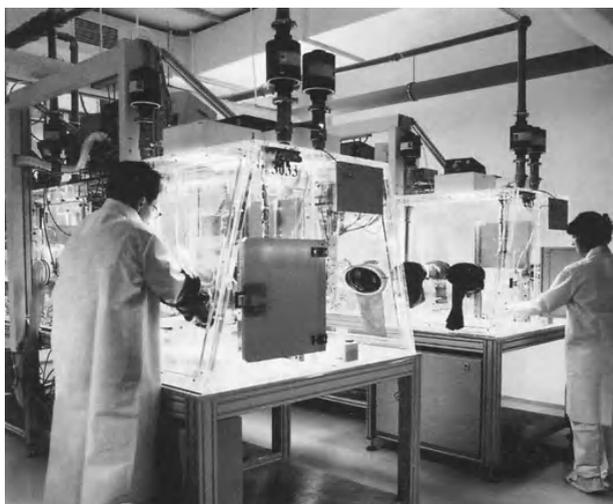
Abb. 132. Produktionsanlage zur Herstellung radioaktiver Ballonkatheter der Eckert u. Ziegler Strahlen- und Medizintechnik AG.
