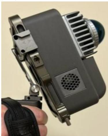
*Рисунок. Внешний вид сканирующего блока мобильного комплекса Л-СКАН Нано*
