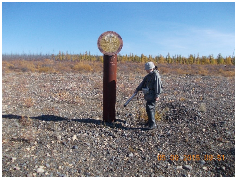
Рис. 3.24. Радиометрические измерения на насыпи объекта ПЯВ «Кратон-3» в сентябре 2015 г. (фото Артамоновой С. Ю.)
