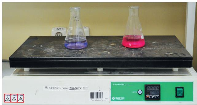
Рис. 2.4. Нагревательная плита
