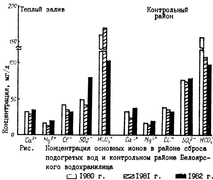
Рис. Концентрация основных ионов в районе сброса подогретых вод и контрольном районе Белоярского водохранилища
