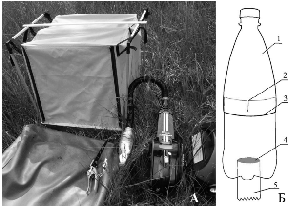
Рис. 1. Внешний вид прибора (А) и схема вакуумного пробосборника (Б): 1 — съёмная часть бутылки, 2 — продольные разрезы, 3 — перпендикулярный разрез, 4 — чехол из мельничного газа, 5 — патрубок воздухозаборника.
