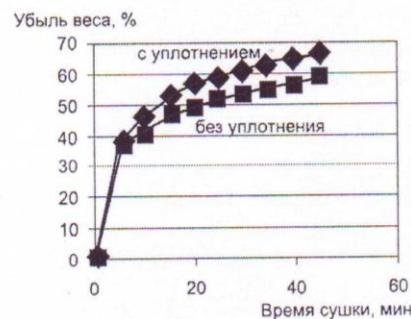
Рис. 6. Динамика сушки смолы КУ-2 при 75 °C и давлении 0,3 атм., с виброуплотнением и без уплотнения
