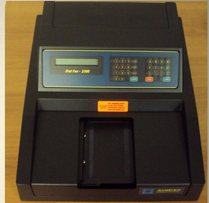
Планшетный иммуноферментный анализатор «StatFax» 2100 («Awareness Technology», США, VIS-модель)
