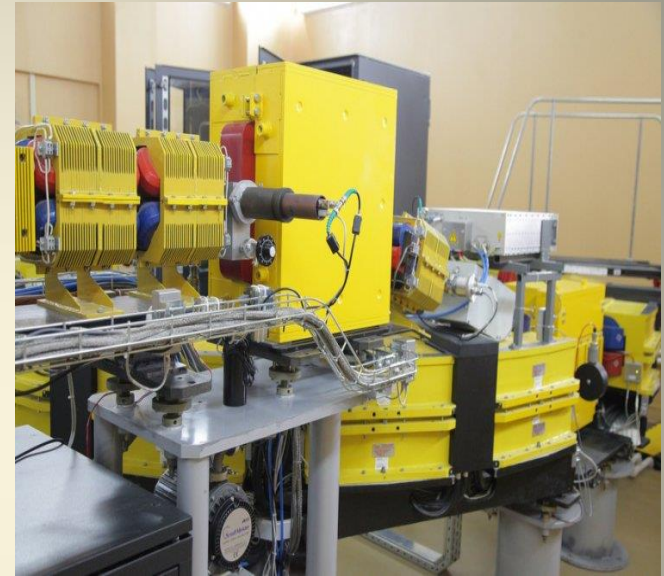
Синхротрон комплекса для протонной терапии «Прометеус» (МРНЦ им. Цыба, г. Обнинск, Россия).
