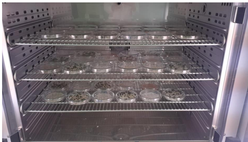
Рисунок 1 – Климакамера с семенами в чашках Петри
